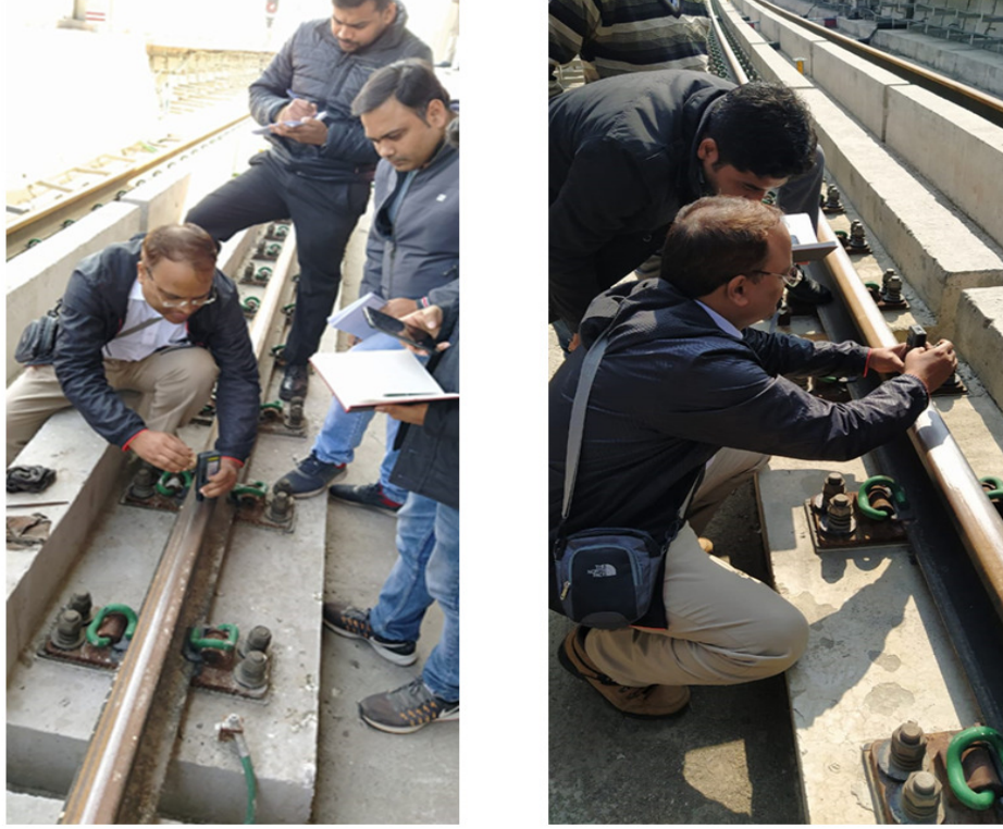
चित्र 2.2: लाइन-7 की पटरियों सतह हार्डनेस का मापन (31 जनवरी 2020 को आईपी विस्तार मेट्रो स्टेशन)
